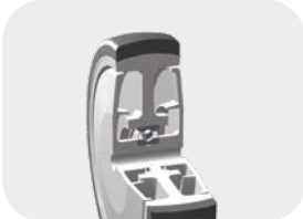
Aufbau Rad: Kugellager, abgedichtet
