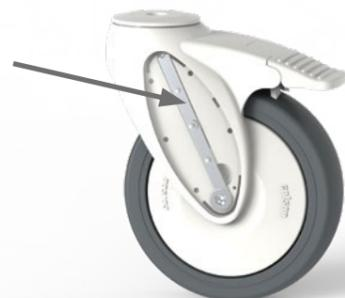
Eine direkte Verbindung von Radnabe und Kugellager durch ein leitfähiges Bauteil ermöglicht die Verwendung der Standardgabel auch für leitfähige Rollen. Weiße und helle Farben können verwendet werden, ohne das Aussehen durch den Einsatz von leitfähigem Material zu beeinträchtigen.
