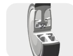
Aufbau Gleitlager: Achsrohr rostfrei, als Sonderausführung lieferbar!
