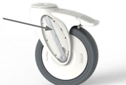
Eine direkte Verbindung von Radnabe und Kugellager durch ein leitfähiges Bauteil ermöglicht die Verwendung der Standardgabel auch für leitfähige Rollen. Weiße und helle Farben können verwendet werden, ohne das Aussehen durch den Einsatz von leitfähigem Material zu beeinträchtigen.
