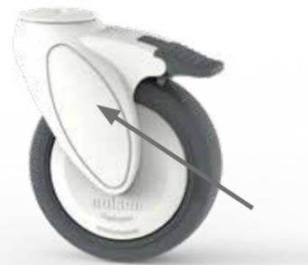
Das neue Design für eine 40mm Nabenbreite ermöglicht den Einsatz von Rädern mit 36mm Laufflächenbreite aus der Perfoma-Serie. Die Tragfähigkeit von 150kg in Verbindung mit einem weichen 65° Shore (A) Reifen ermöglicht den Einsatz der VIVAX® Rollen für viele neue Anwendungsbereiche und eröffnet so eine neue Verwendungsdimension für Apparate- & Transportrollen aus Kunststoff.
