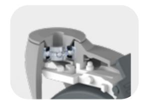
Aufbau Schwenklager mit Rillenkugellager 6203 2RS DIN 625
